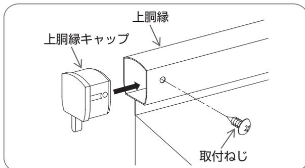
上胴縁キャップを上胴縁の端部に差し込み、プラスドライバーで取付ねじをしめる。
