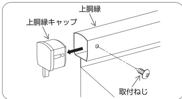
プラスドライバーで上胴縁キャップの取付ねじをはずし、上胴縁キャップをはずす。
