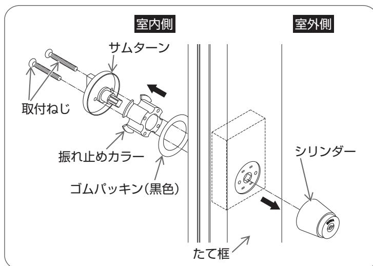
室内側よりプラスドライバーでサムターンの取付ねじをはずし、サムターンおよびシリンダー、振れ止めカラ、ゴムパッキン（黒色）をはずす。
