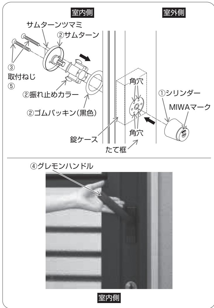
①室外側よりシリンダーの MIWA マークを上にしてシリンダーを錠ケースの角穴に差し込む。
