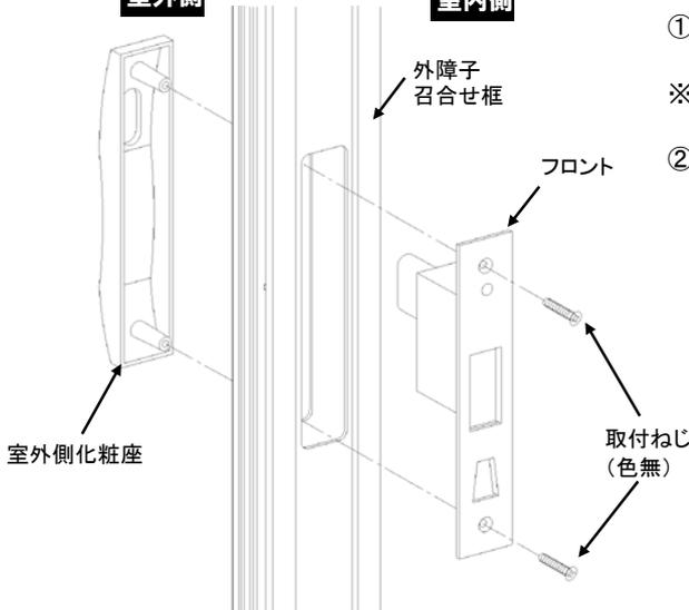
①室外側より室外側化粧座、室内側よりフロントを取付穴に差し込み、
