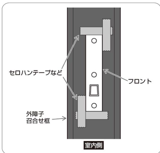
外障子の召合せ框の室内側に取り付いているフロントの角部にセロハンテープなどを使って取り付け位置に印を付ける。
