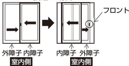
室内側より内障子と外障子を行き違わせて外障子の召合せ錠フロントを見えるようにする。
