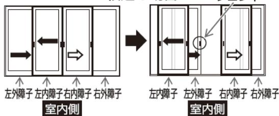
室内側より左側の内障子と外障子を行き違わせ左側の外障子の召合せ錠フロントを見えるようにする。
