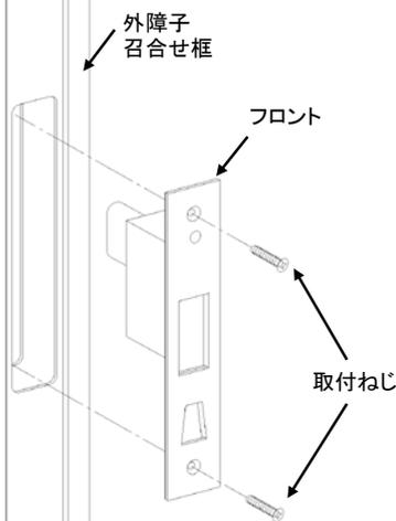
室内側よりプラスドライバーでフロントの取付ねじをはずし、フロントおよび室外側化粧座をはずす。
