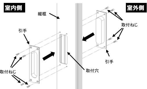
室内側・室外側よりそれぞれ引手を取付穴に差し込み、プラスドライバーで取付ねじを締める。
