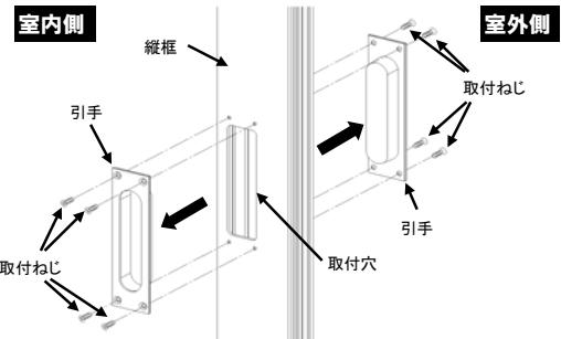
室内側・室外側よりそれぞれプラスドライバーで引手の取付ねじをはずし、引手をはずす。
