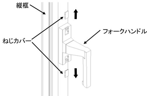
マイナスドライバーをねじカバーの角穴に差し込み、ねじカバーをはずす。
