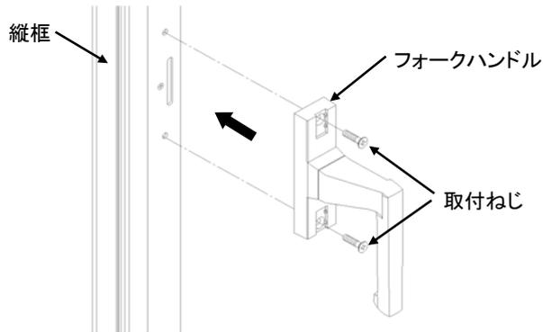
フォークハンドルを取付穴に差し込み、プラスドライバーで取付ねじをしめる。
