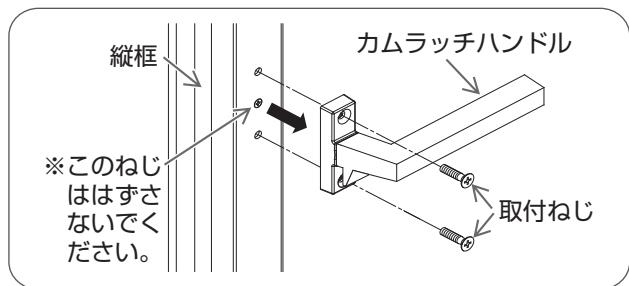
カムラッチハンドルを水平にし、プラスドライバーでカムラッチハンドルの取付ねじをはずし、カムラッチハンドルをはずす。
