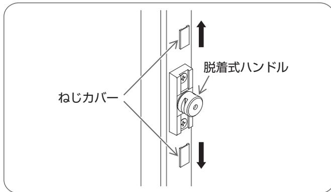
マイナスドライバーをねじカバーの角穴に差し込み、ねじカバーをはずす。
