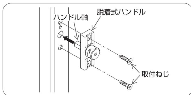
ハンドル軸を取付穴に差し込み、プラスドライバーで取付ねじをしめる。
