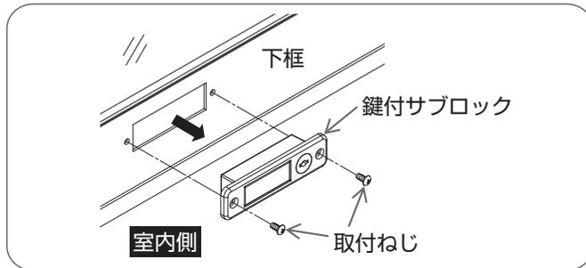
室内側よりプラスドライバーで鍵付サブロックの取付ねじをはずし、鍵付サブロックをはずす。
