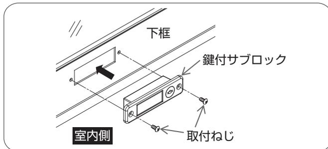
室内側より鍵付サブロックを取付穴に差し込み、プラスドライバーで取付ねじをしめる。
