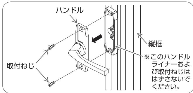
ハンドルを水平にし、プラスドライバーでハンドルの取付ねじをはずし、ハンドルをはずす。
