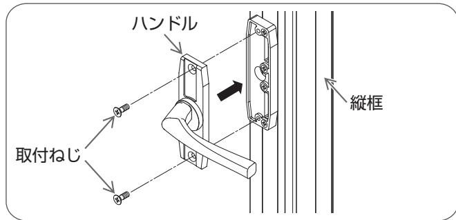
ハンドルを取付穴に差し込み、プラスドライバーで取付ねじをしめる。
