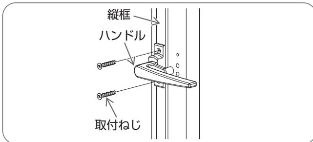
ハンドルを水平にし取付穴に差し込み、プラスドライバーでハンドルの取付ねじをしめる。
