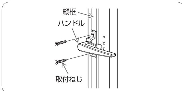
ハンドルを水平にし、プラスドライバーでハンドルの取付ねじをはずし、ハンドルをはずす。
