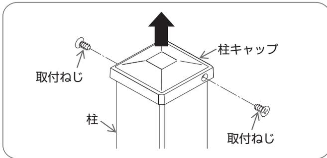
プラスドライバーで柱キャップの取付ねじをはずし、柱キャップをはずす。
