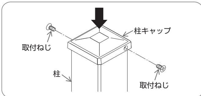
柱キャップと柱のねじ穴の位置を合わせて、プラスドライバーで柱キャップの取付ねじをしめる。
