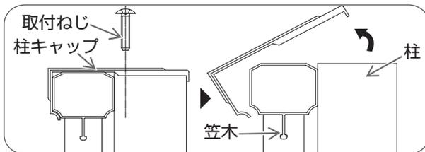
プラスドライバーで柱キャップの取付ねじをはずし、柱キャップを起こしてははずし、柱キャップを起こしてははずし。
