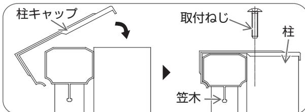
柱キャップ先端を笠木に引っ掛けて柱にかぶせ、プラスドライバーで取付ねじをしめる。
