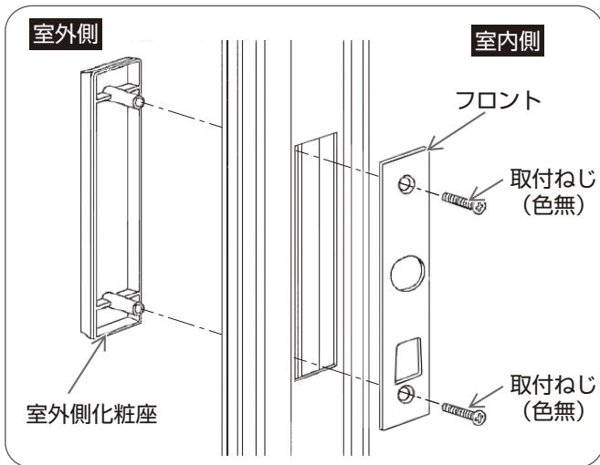
①フロントと室外側化粧座を取付穴に差し込み、プラスドライバーで取付ねじをしめる。
