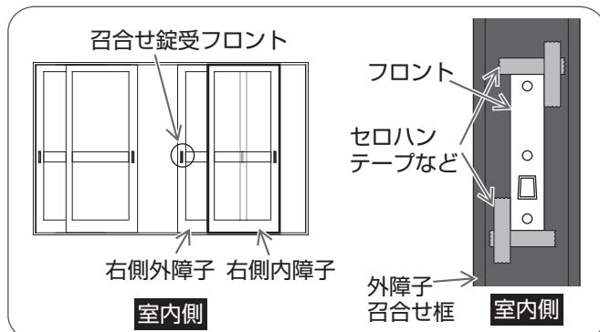
外障子の召合せ框の室内側に取り付いているフロントの角部にセロハンテープなどを使って取り付け位置に印を付ける。
