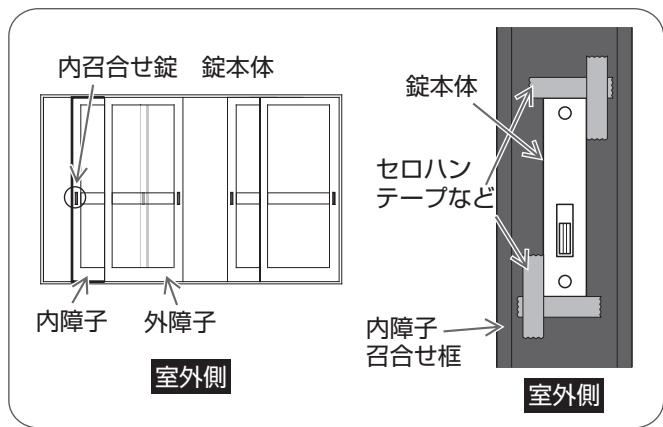
内障子の召合せ框の室外側に取り付いている錠本体の角部にセロハンテープなどを使って取り付け位置に印を付ける。
