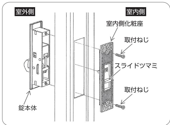
室内側よりプラスドライバーで室内側化粧座の取付ねじをはずし、室内側化粧座および錠本体をはずす。
