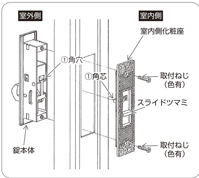
①室内側化粧座と錠本体を取付穴に差し込み、プラスドライバーで取付ねじを仮止めする。
