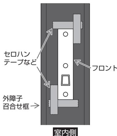
外障子の召合せ枠の室内側に取り付いているフロントの角部にセロハンテープなどを使って取り付け位置に印を付ける。
