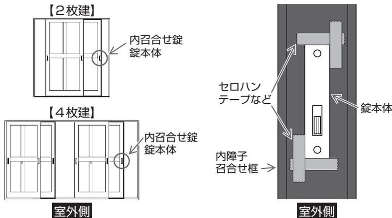
内障子の召合せ框の室外側に取り付いている錠本体の角部にセロハンテープなどを使って取り付け位置に印を付ける。
