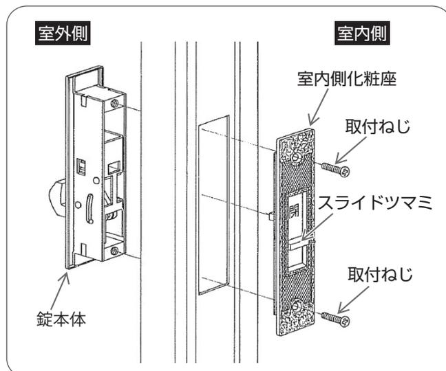
室内側よりプラスドライバーで室内側化粧座の取付ねじをはずし、室内側化粧座および錠本体をはずす。
