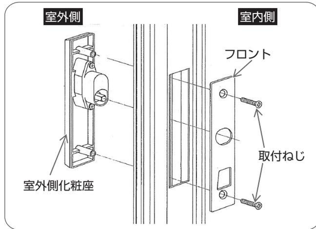
室内側よりプラスドライバーでフロントの取付ねじをはずし、フロントおよび室外側化粧座をはずす。
