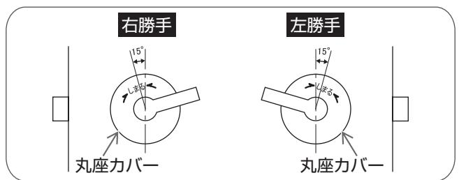
②丸座カバーの刻印を勝手に合わせ、丸座に取り付ける。
