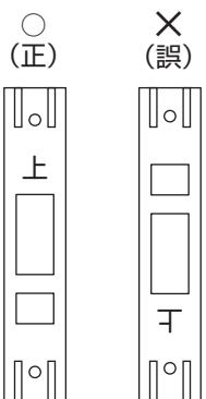
錠ケースをラベル（下図参照）に従って取付穴に差し込み、フロントを合わせ、プラスドライバーで取付ねじをしめる。
