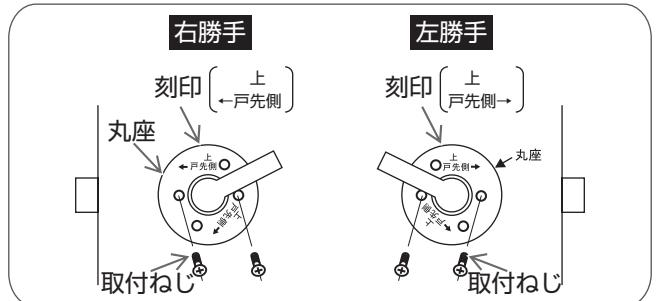
①丸座の刻印を勝手に合わせ、プラスドライバーで取付ねじをしめる。
