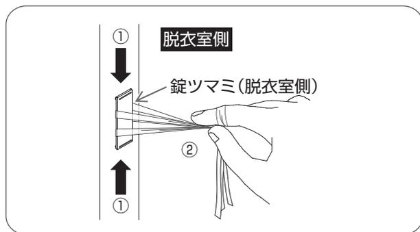
①錠ツマミの上下から錠ツマミと縦枠との間にすき間にひもを通す。
