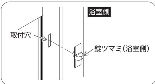
錠ツマミ (浴室側) を縦枠の取付穴内部の部品にはめ込む。
