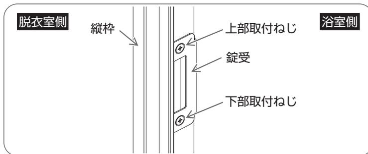
プラスドライバーで上部および下部取付ねじをはずす。
