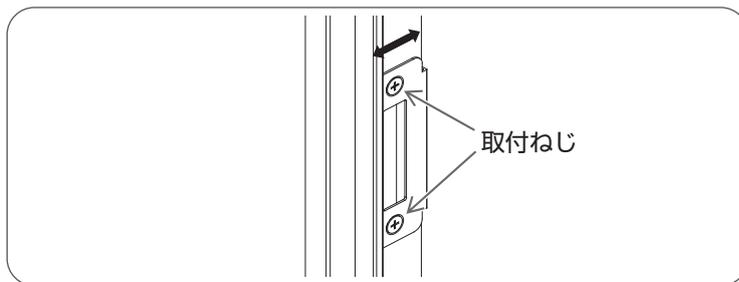
錠受の取付ねじをゆるめ左右に調整後、取付ねじをしめる。
