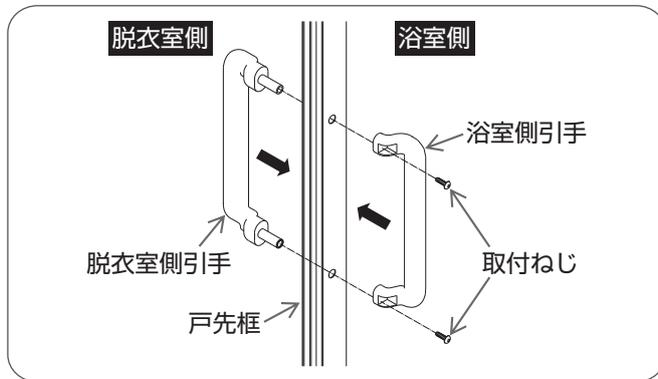
浴室側より浴室側引手，脱衣室側より脱衣室側引手を取付穴に差し込み、プラスドライバーで取付ねじをしめる。
