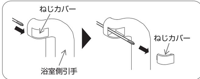
浴室側ハンドル裏面の穴にプラスドライバーを差し込み、ねじカバーをはずす。
