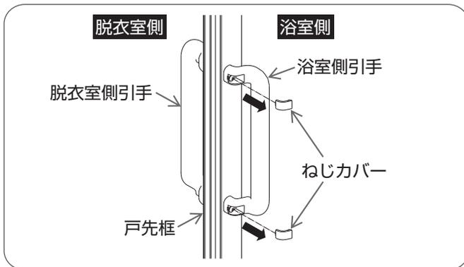
浴室側よりねじカバーの溝にマイナスドライバーを差し込み、ねじカバーをはずす。
