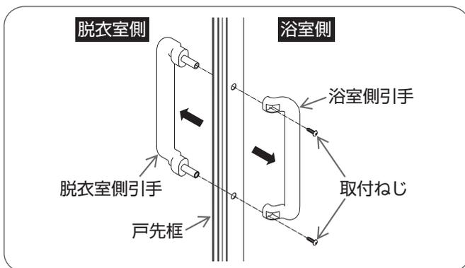
浴室側よりプラスドライバーで浴室側引手の取付ねじをはずし、浴室側引手および脱衣室側引手をはずす。
