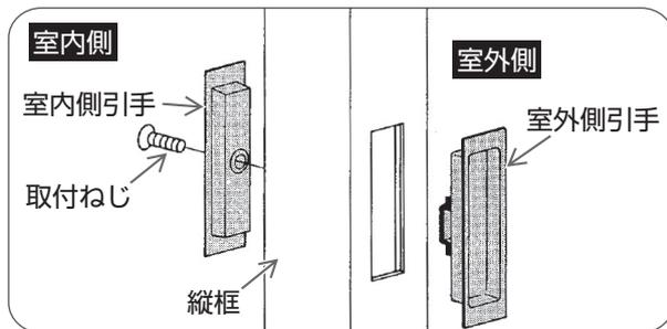
室内側よりプラスドライバーで室内側引手の取付ねじをはずし、室内側および室外側引手をはずす。
