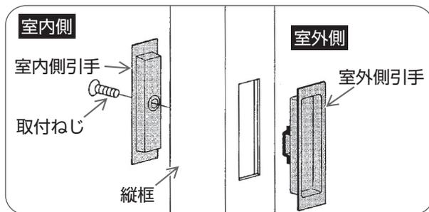
室内側より室内側引手、室外側より室外側引手を取付穴に差し込み、プラスドライバーで取付ねじをしめる。
