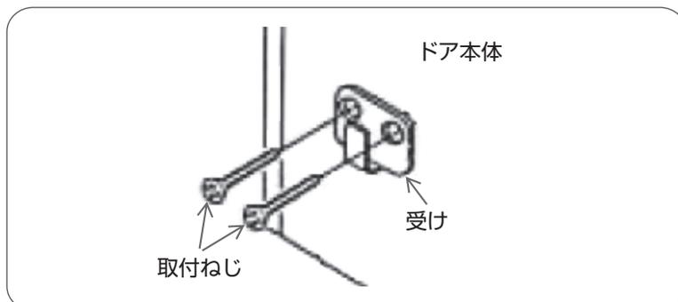
プラスドライバーで受けの取付ねじをはずし、受けをはずす。
