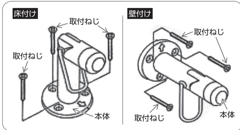
プラスドライバーで本体の取付ねじをはずし、本体をはずす。
