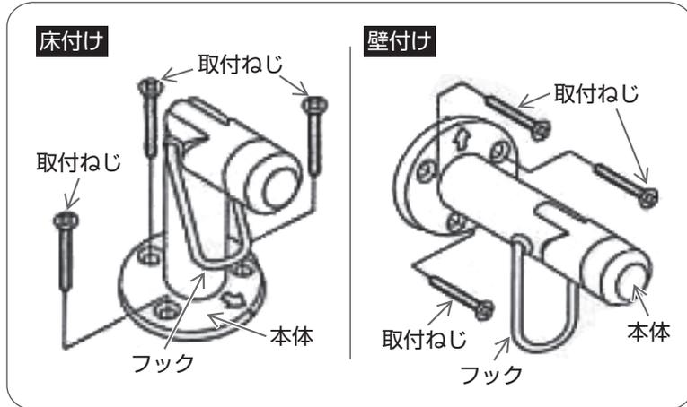
本体を取付穴に合わせ、プラスドライバーで取付ねじをしめる。
