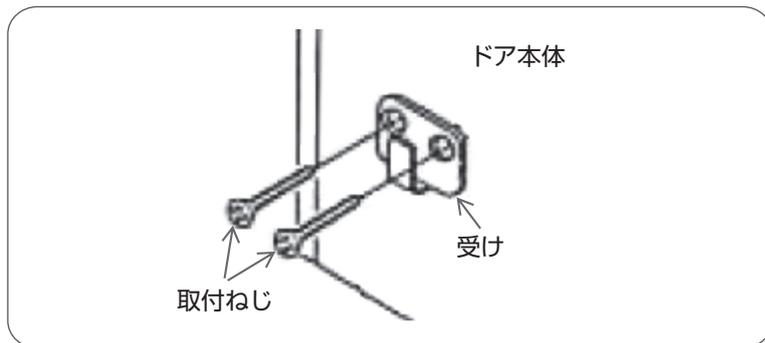
受けを取付穴に合わせ、プラスドライバーで取付ねじをしめる。
