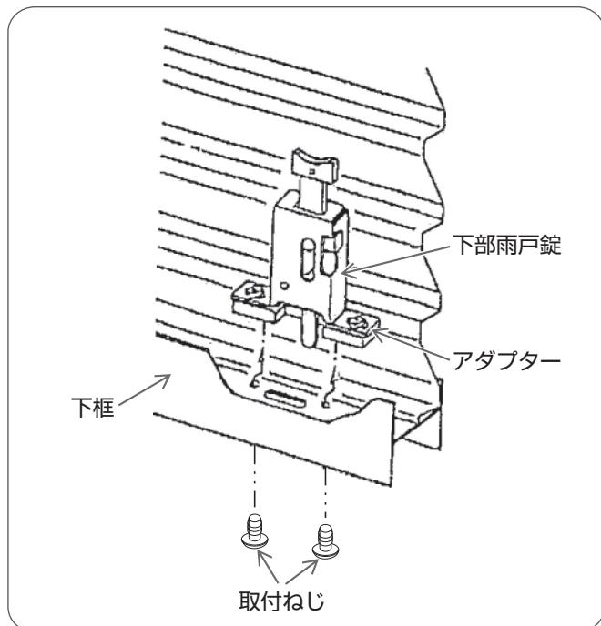
プラスドライバーで下側から下部雨戸錠の取付ねじをはずし、下部雨戸錠（アダプター付）をはずす。
