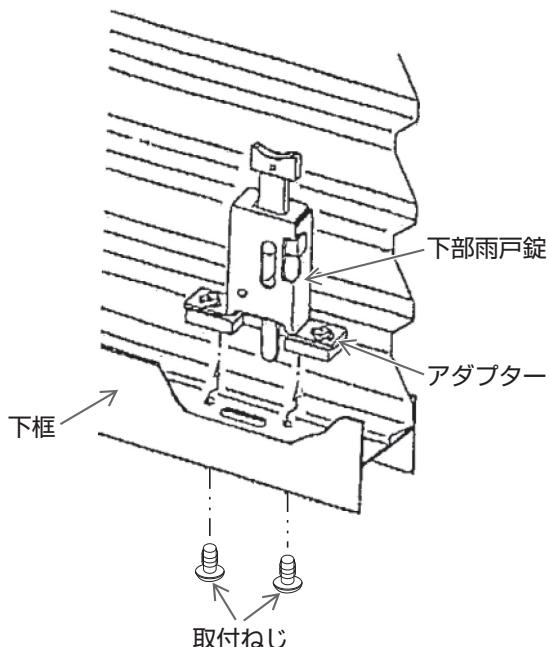
下部雨戸錠（アダプター付）を下框の取付穴に合わせ、プラスドライバーで下側から取付ねじをしめる。
