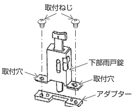
アダプターを下部雨戸錠の取付穴に合わせ、プラスドライバーで取付ねじをしめる。
