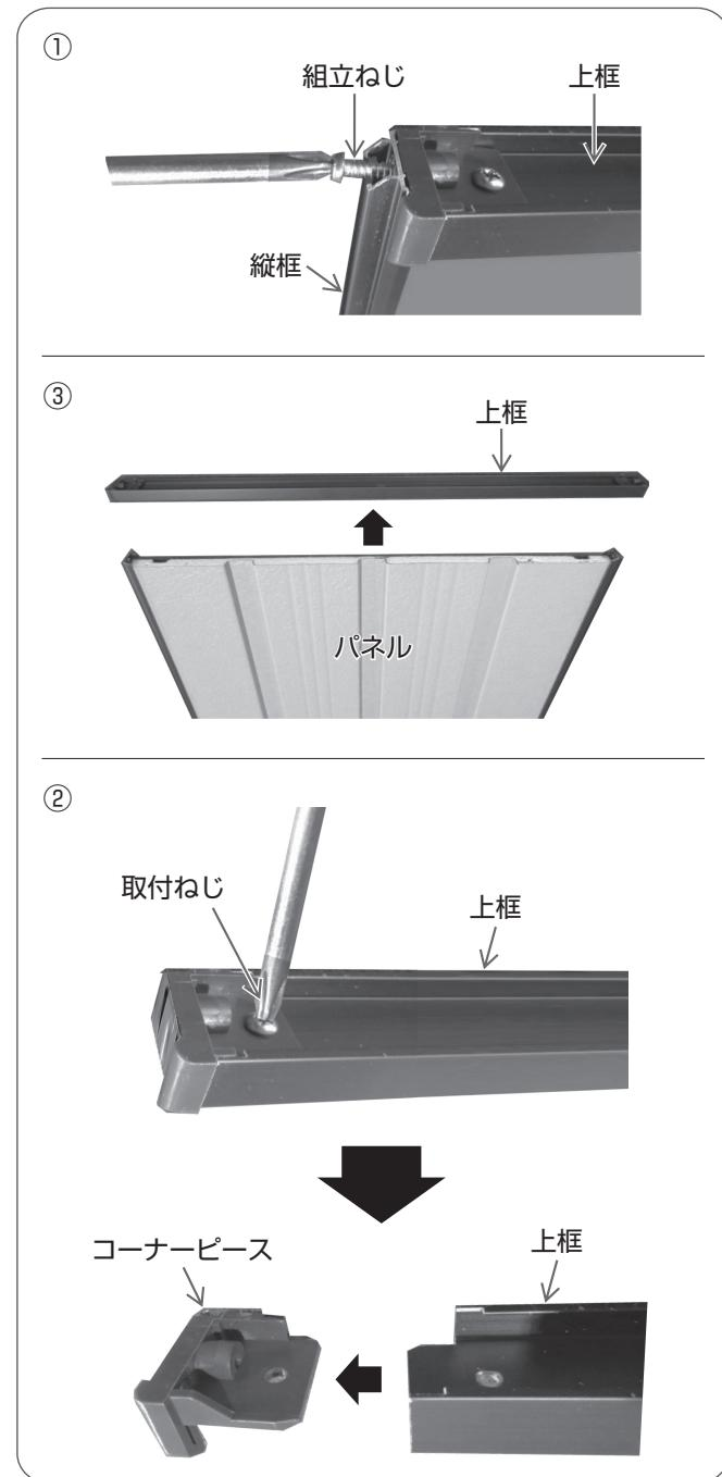
①プラスドライバーで上框（下框）の左右の組立ねじをはずす。
