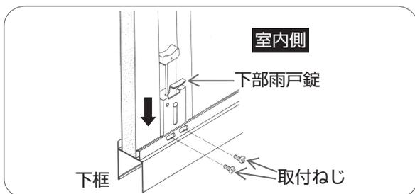
室内側より下部雨戸錠を下框の取付穴に差し込み、プラスドライバーで取付ねじをしめる。
