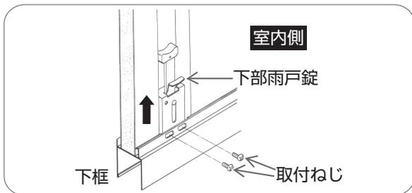
室内側よりプラスドライバーで下部雨戸錠の取付ねじをはずし、下部雨戸錠をはずす。
