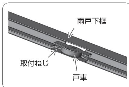
プラスドライバーで戸車をとめている取付ねじをはずし、戸車をはずす。
