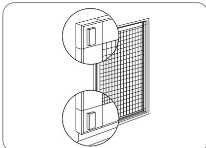
はずれ止めをセットし、網戸がはずれないことを確認してください。
