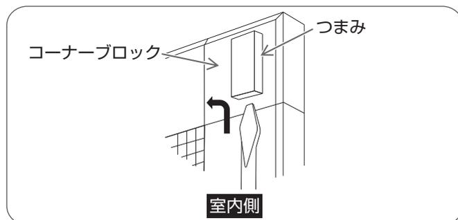
室内側よりつまみとコーナブロックの隙間にマイナスドライバーを差し込み、つまみおよび引寄せ片をはずす。
