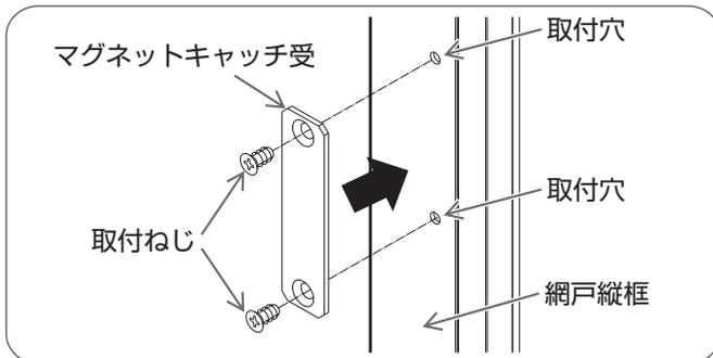
マグネットキャッチ受を取付穴に合わせ、プラスドライバーで取付ねじをしめる。
