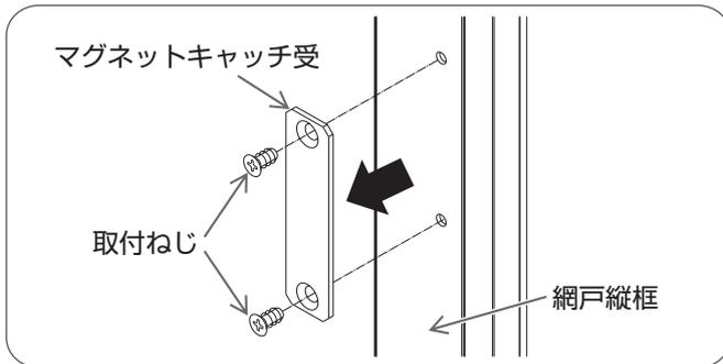
プラスドライバーでマグネットキャッチ受の取付ねじをはずし、マグネットキャッチ受をはずす。
