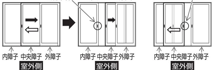
室外側より中央の障子を外障子側又は内障子側に開けて左右の錠本体を見えるようにする。
