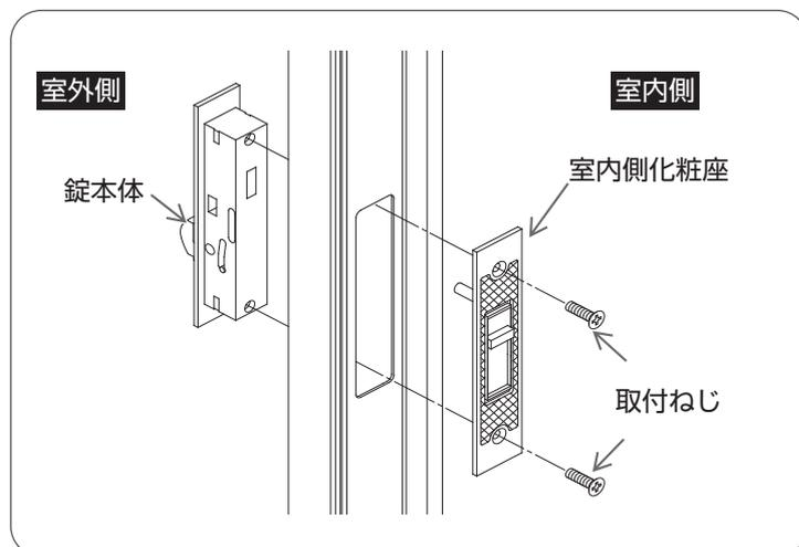
室内側よりプラスドライバーで室内側化粧座の取付ねじをはずし、室内側化粧座および錠本体をはずす。
