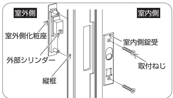
室内側よりプラスドライバーで取付ねじをはずし、部品をはずす。
