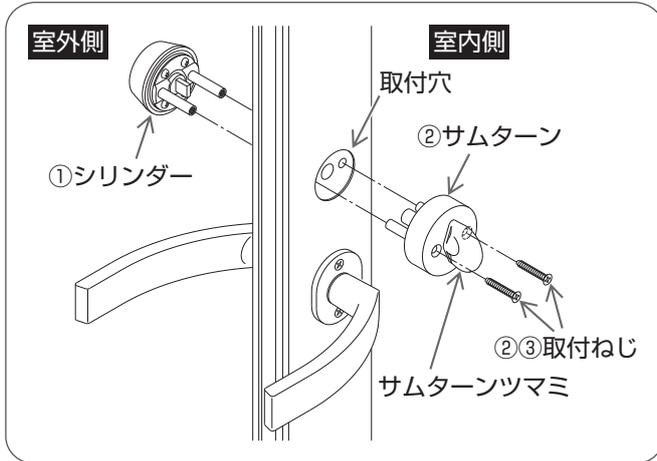
① 室外側よりMIWAマークを上側にしてシリンダーを取付穴に差し込む。
