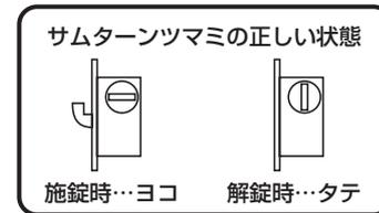
③ サムターンツマミを数回動かし、動きのよいところで取付ねじをしめる。
