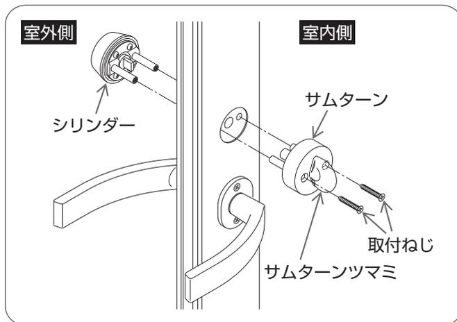
室内側よりプラスドライバーでサムターンの取付ねじをはずし、サムターンをはずす。
