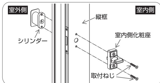
室内側よりプラスドライバーで室内側化粧座の取付ねじをはずし、室内側化粧座およびシリンダーをはずす。
