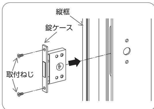
錠ケースを取付穴に差し込み、プラスドライバーで取付ねじをしめる。
