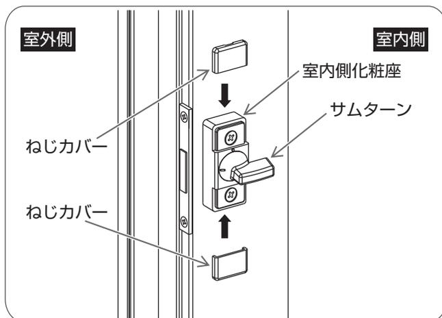
室内側化粧座の上下にねじカバーを取り付ける。
