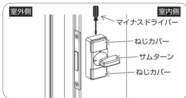
サムターンを水平に回し、室内側化粧座上下のねじカバーの角穴にマイナスドライバーを差し込んではずす。
