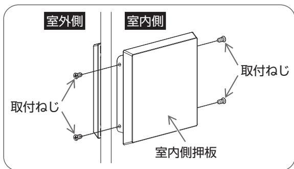
室内側よりプラスドライバーで室内側押板の取付ねじをはずし、室内側押板をはずす。
