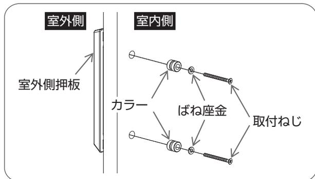
室外側より室外側押板、室内側よりカラーとばね座金を取付穴に合わせ、プラスドライバーで取付ねじをしめる。
