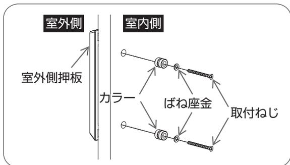
室内側よりプラスドライバーで室外側押板の取付ねじをはずし、室外側押板・カラー・ばね座金をはずす。
