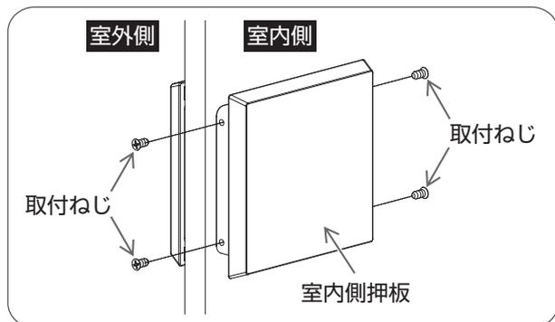
室内側より室内側押板の取付部をカラーに差し込み、プラスドライバーで室内側押板の取付ねじをしめる。
