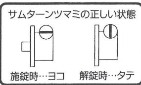
③プラスドライバーで取付ねじを仮止めし、サムターンツマミを数回作動させ、動きのよい所でしめる。
