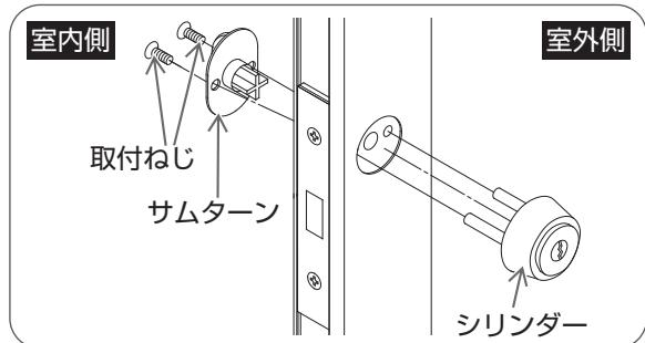
室内側よりプラスドライバーでサムターンの取付ねじをはずし、サムターンおよびシリンダーをはずす。
