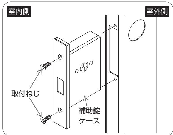
錠ケースを取り付け穴に差し込み、プラスドライバーで取付ねじをしめる。
