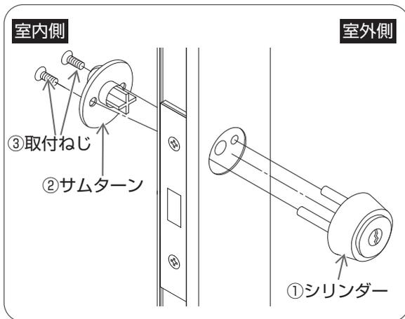
① 室外側よりシリンダーを錠ケースの取付穴に差し込む。
