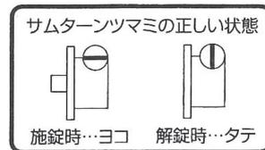
③ プラスドライバーで取付ねじを仮止めし、サムターンツマミを数回作動させ、動きのよい所でしめる。
