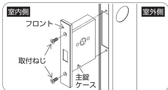
プラスドライバーで錠ケースの取付ねじをはずし、錠ケースをおよびフロントをはずす。
