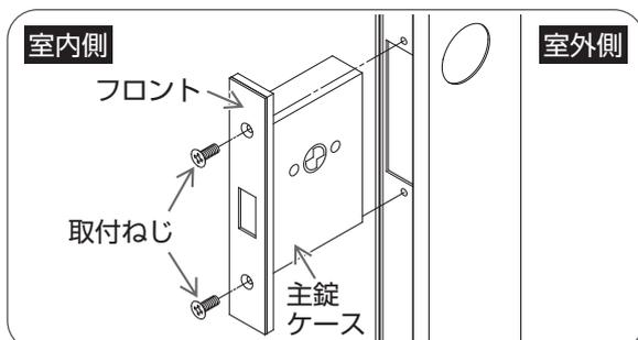
プラスドライバーで錠ケースの取付ねじをはずし、錠ケースおよびフロントをはずす。
