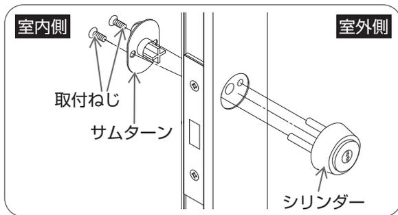
室内側よりプラスドライバーでサムターンの取付ねじをはずし、サムターンおよびシリンダーをはずす。
