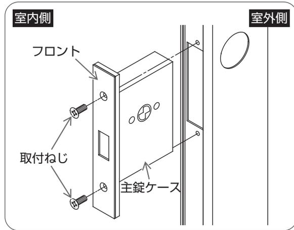
錠ケースを取付穴に差し込み、フロントを合わせプラスドライバーで取付ねじをしめる。
