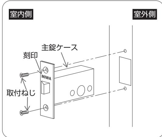
錠ケースを取付穴に差し込み、プラスドライバーで取付ねじをしめる。
