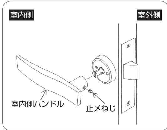
室内側より室内側ハンドルを室内側丸座の角軸に差し込み、プラスドライバーで止めねじをしめる。
