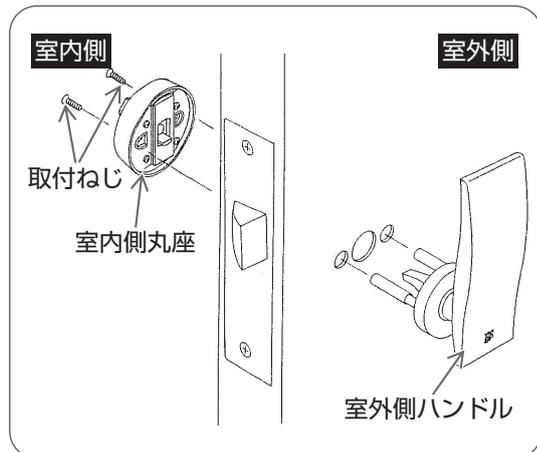
室内側よりプラスドライバーで室内側丸座の取付ねじをはずし、室内側丸座および室外側ハンドルをはずす。
