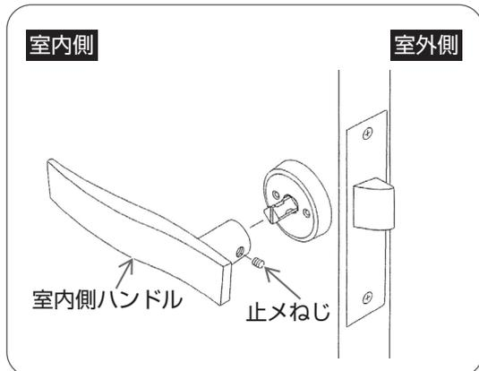
室内側よりプラスドライバーで室内側ハンドルの止めねじをはずし、室内側ハンドルをはずす。
