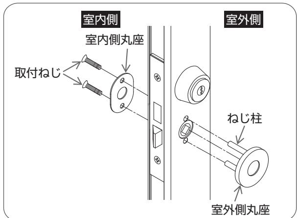
室内側よりプラスドライバーで室内側丸座の取付ねじをはずし、室内側および室外側丸座をはずす。
