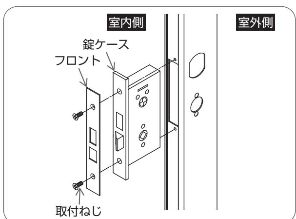
プラスドライバーで錠ケースの取付ねじをはずし、錠ケースおよびフロントをはずす。
