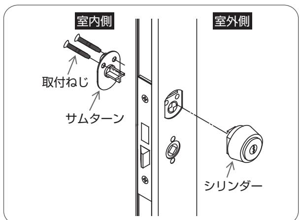
室内側よりプラスドライバーでサムターンの取付ねじをはずし、サムターンおよびシリンダーをはずす。
