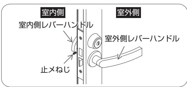
プラスドライバーで室内側ハンドルの止メねじをしめる。
