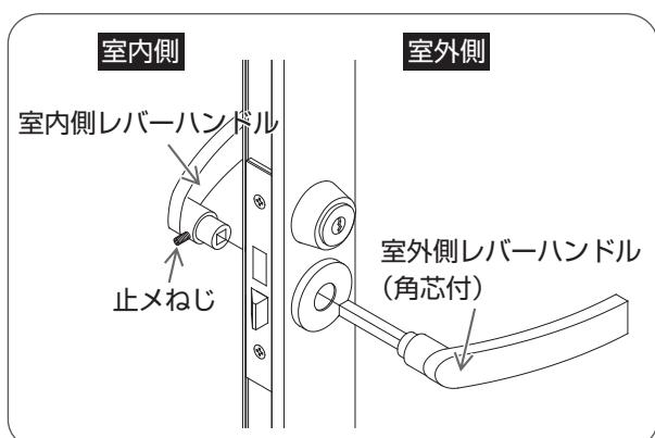
室内側よりプラスドライバーで室内側ハンドルの止メねじをはずし、室内側および室外側ハンドルをはずす。
