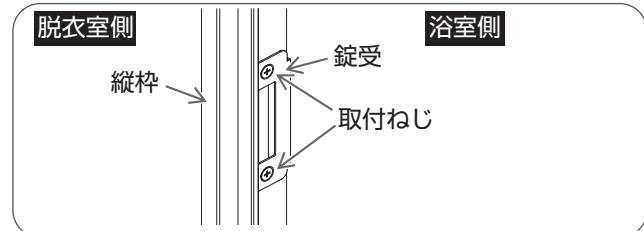
プラスドライバーで上部および下部取付ねじをしめる。
