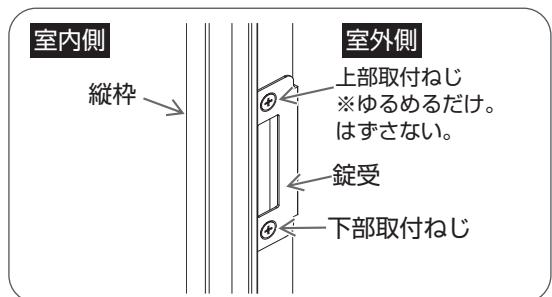
プラスドライバーで下部取付ねじをはずし、上部取付けねじをゆるめる。
