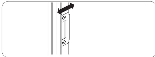
錠受の取付ねじをゆるめ左右に調整後、取付ねじをしめる。
