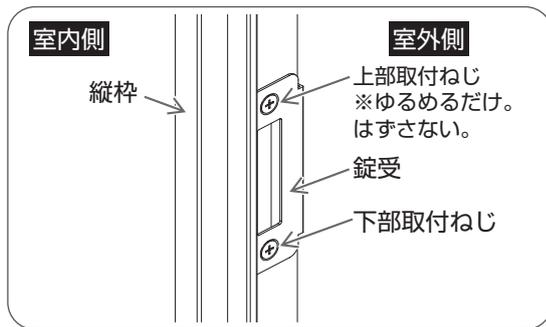
プラスドライバーで下部取付ねじをはずし、上部取付ねじをゆるめる。
