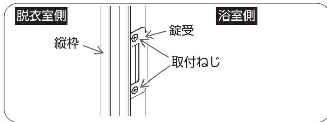
プラスドライバーで上部および下部取付ねじをしめる。
