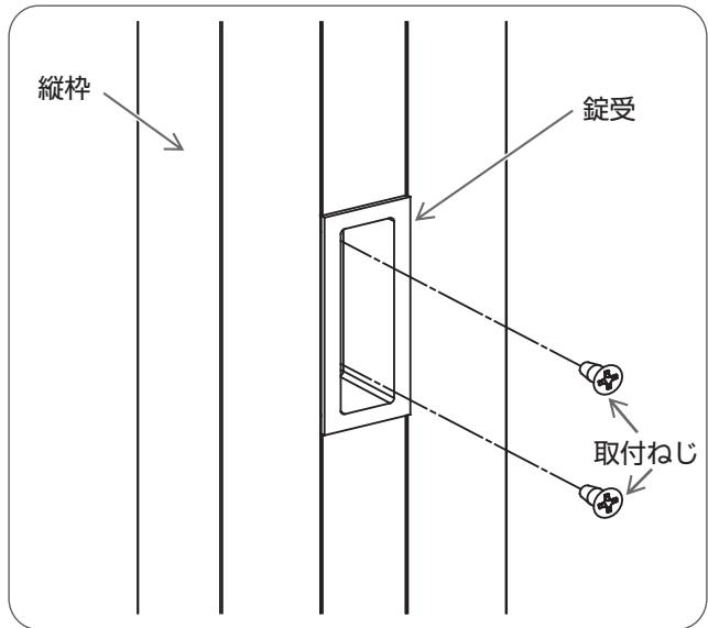
錠受を縦枠の取付穴に合わせ、プラスドライバーで取付ねじをしめる。
