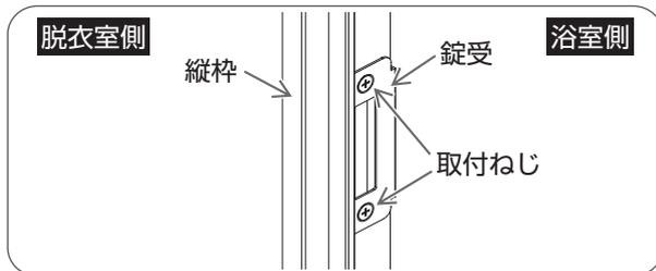
プラスドライバーで上部および下部取付ねじをしめる。
