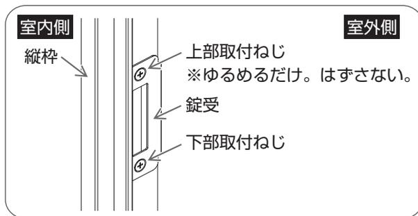
プラスドライバーで下部取付ねじをはずし、上部取付ねじをゆるめる。
