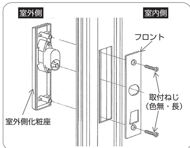
室内側よりプラスドライバーでフロントの取付ねじをはずし、フロントおよび室外側化粧座をはずす。
