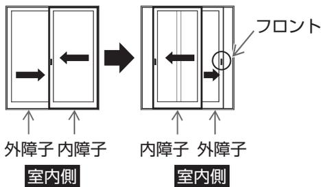
室内側より内障子と外障子を行き違わせて外障子の召合せ錠フロントを見るようにする。
