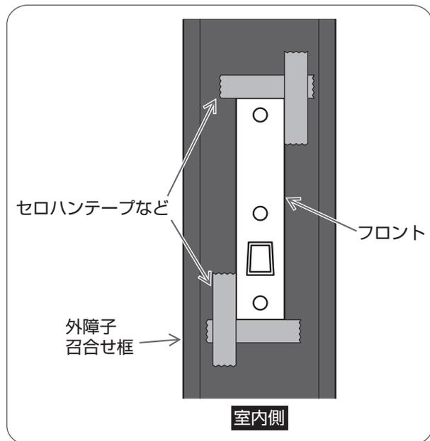
外障子の召合せ框の室内側に取り付けられているフロントの角部にセロハンテープなどを使って取り付け位置に印を付ける。
