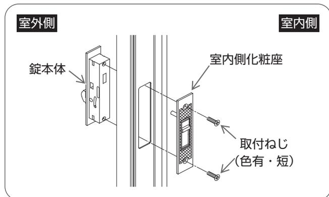
室内側よりプラスドライバーで室内側化粧座の取付ねじをはずし、室内側化粧座および錠本体をはずす。
