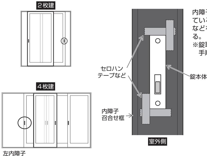
内障子の召合せ框の室外側に取り付けている錠本体の角部にセロハンテープなどを使って取り付け位置に印を付ける。
