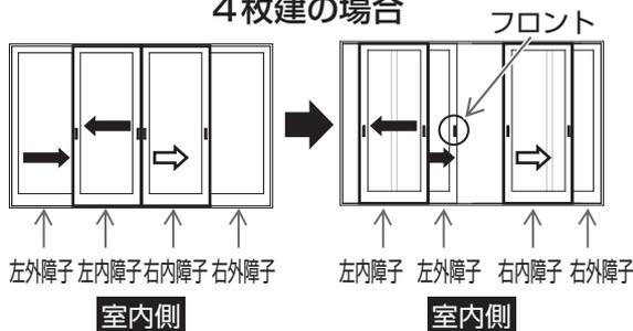
室内側より左側の内障子と外障子を行き違わせて左側の外障子の召合せ錠フロントを見るようにする。
