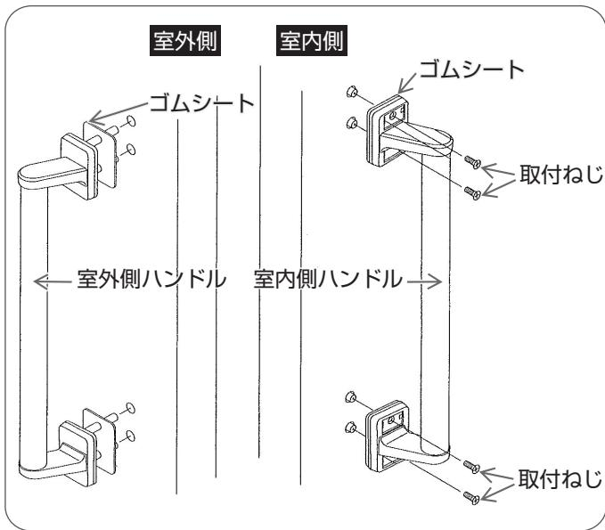
室内側よりプラスドライバーで室内側ハンドルの取付ねじをはずし、室内側ハンドルおよび室外側ハンドルをはずす。
