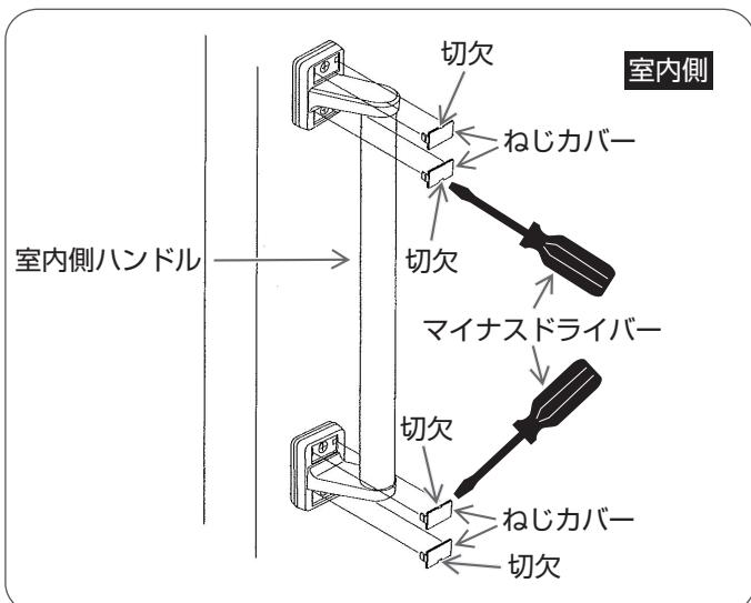
室内側よりマイナスドライバーをねじカバーの切欠に差し込んで、ねじカバーをはずす。
