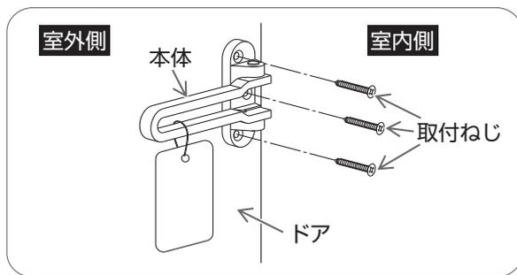
室内側よりプラスドライバーで本体の取付ねじをはずし、本体をはずす。
