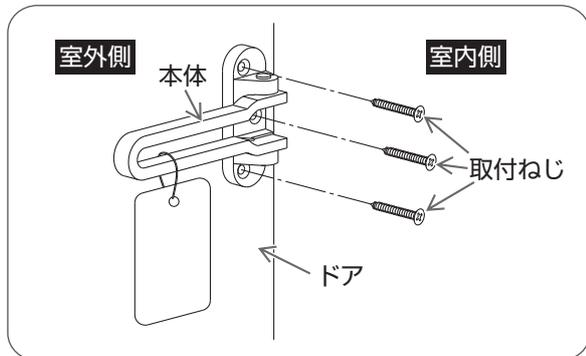
室内側より本体を取付穴に合わせ、プラスドライバーで取付ねじをしめる。
