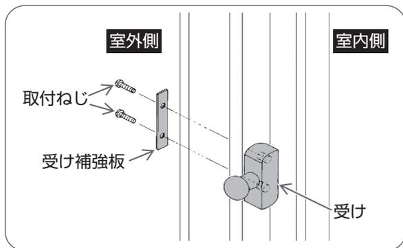
室内側より受け、室外側より受け補強板を取付穴に合わせ、プラスドライバーで取付ねじをしめる。
