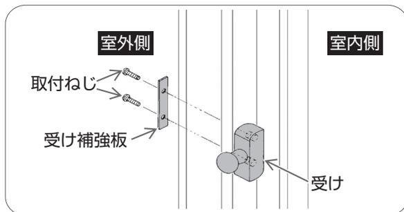
室外側よりプラスドライバーで受けの取付ねじをはずし、受けをはずす。
