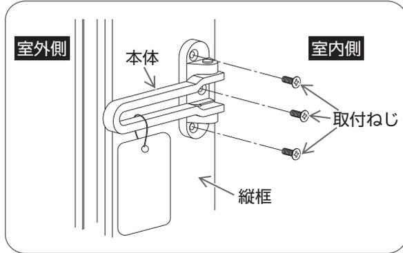
室内側より本体を取付穴に合わせ、プラスドライバーで取付ねじをしめる。
