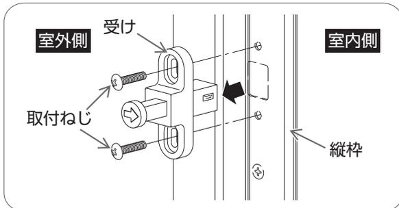
室内側よりプラスドライバーで受けの取付ねじをはずし、受けをはずす。
