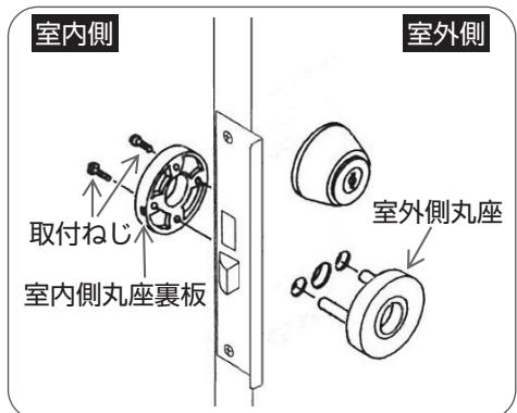
室内側よりプラスドライバーで室内側丸座裏板の取付ねじをはずし、室内側丸座裏板および室外側丸座をはずす。
