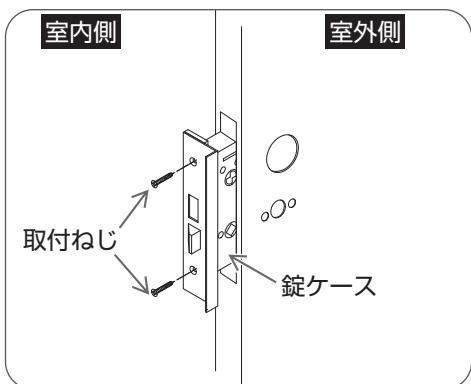
錠ケースを取り付穴に差し込み、プラスドライバーで取付ねじをしめる。
