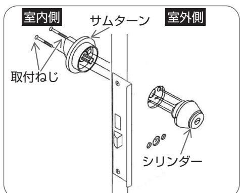
室内側よりプラスドライバーでサムターンの取付ねじをはずし、サムターンおよびシリンダーをはずす。
