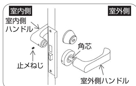
室内側よりプラスドライバーで室内側ハンドルの止メねじをはずし、室内側および室外側ハンドルをはずす。
