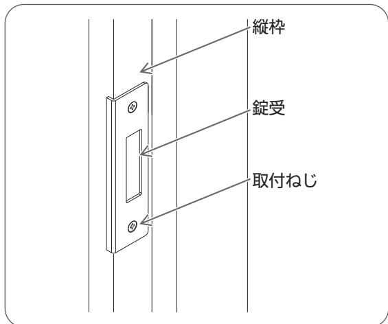
プラスドライバーで縦枠の錠受の取付ねじをはずし、
