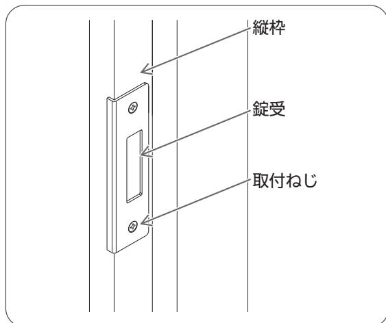
錠受を縦枠の取付穴に合わせ、プラスドライバーで取付ねじをしめる。
