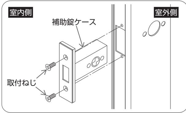
錠ケースを取付穴に差し込み、プラスドライバーで取付ねじをしめる。
