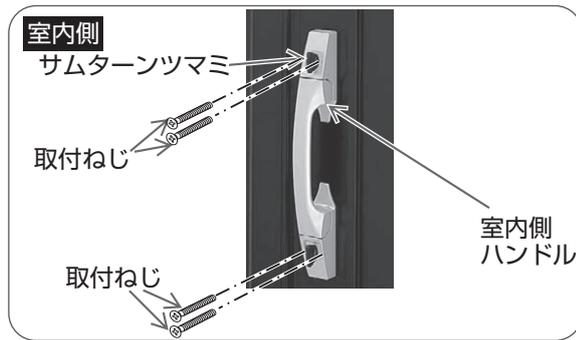
室内側より室内側ハンドルの取付ねじをプラスドライバーではずし、室内側および室外側ハンドルをはずす。
