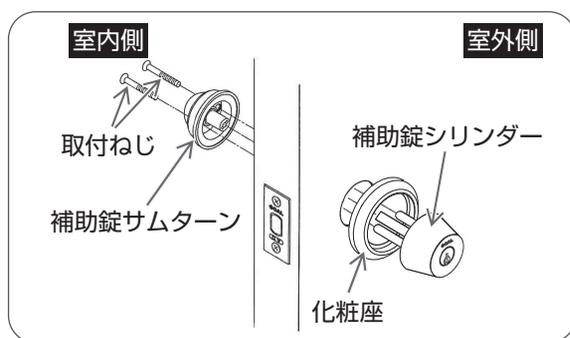
室内側よりプラスドライバーでサムターンの取付ねじをはずし、サムターンおよびシリンダー、化粧座をはずす。
