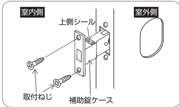
補助錠ケースの「上側」シールを上側にして、取付穴に差し込み、プラスドライバーで取付ねじをしめる。
