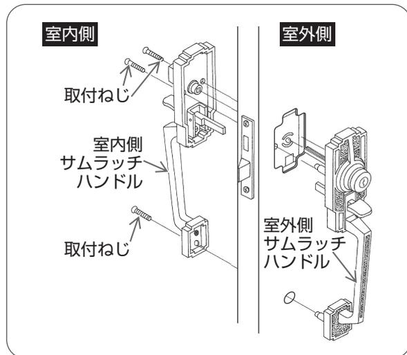
室内側よりプラスドライバーでハンドルの取付ねじをはずし、室内側および室外側ハンドルをはずす。
