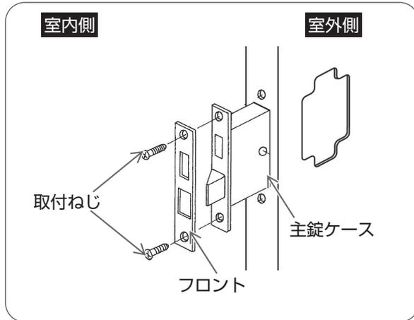
プラスドライバーで錠ケースの取付ねじをはずし、フロントおよび錠ケースをはずす。
